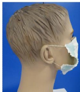
Importantes ouvertures latérales + élastiques à renforcer et assouplir
